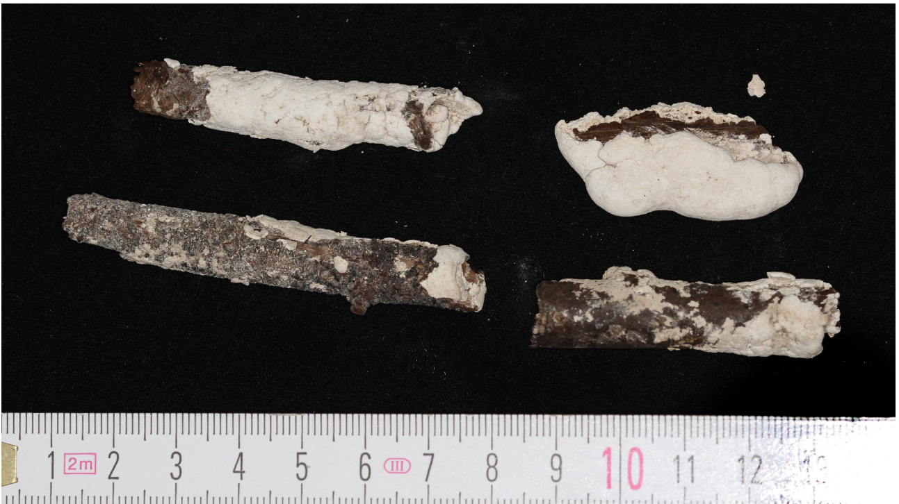
Abb. 7: Schwach versinterte Zweige und ein Holzstück mit fragiler Kruste
